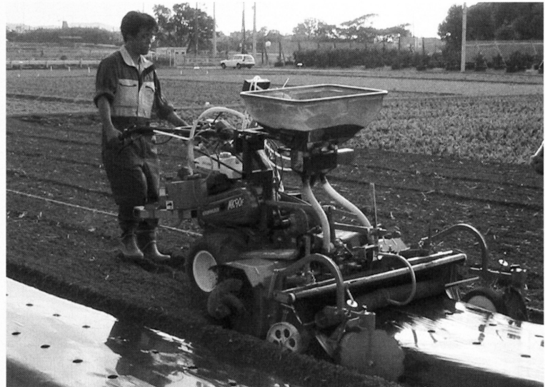
図6. 歩行用テラ型の畝立て成型マルチャに施肥機を装着
